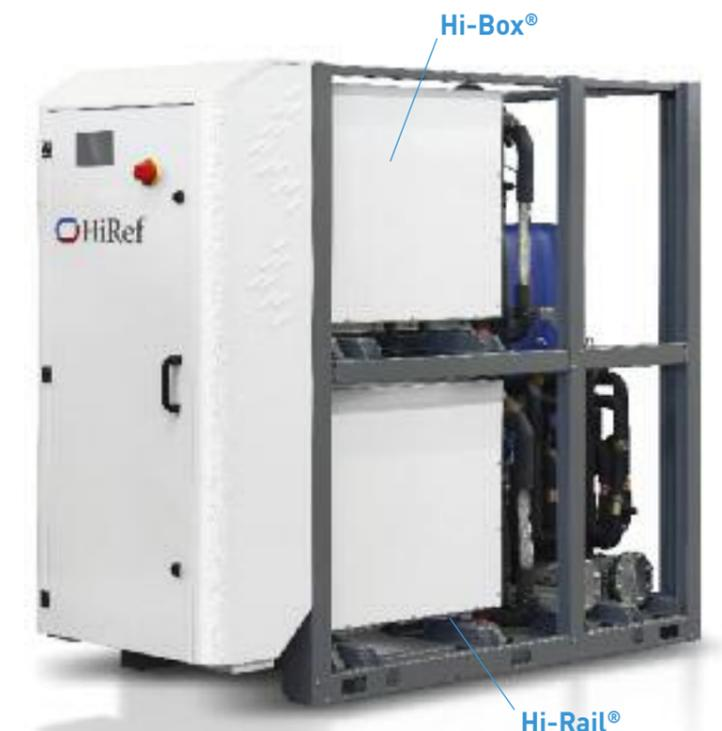
Die Kompressoren werden in einer neu entwickelten Schalldämmbox (Hi-Box®) für eine sehr geringe Geräuschentwicklung gekapselt. Die Verdichtereinheiten können auf Schienen seitlich für Wartungs- und Reparaturzwecke aus dem Gerätegehäuse ausgezogen werden (Hi-Rail®).
