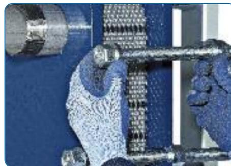
Montage der Spannbolzen
